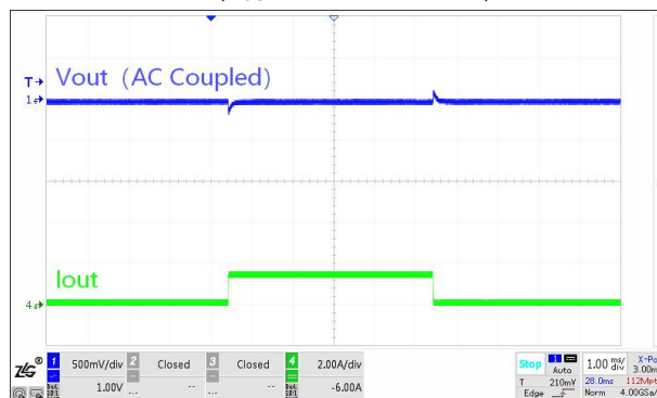
动态负载 V_{IN}=24V , I_{OUT}=0.1A \sim 1.5A \sim 0.1A , 3A/us
