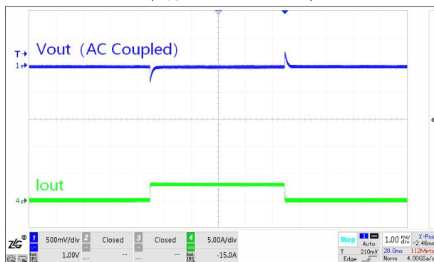
动态负载 V_{IN}=24V , I_{OUT}=0.1A \sim 3A \sim 0.1A , 3A/us
