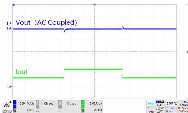
动态负载 I_{OUT}=1.5A \sim 3A \sim 1.5A , 3A/us
